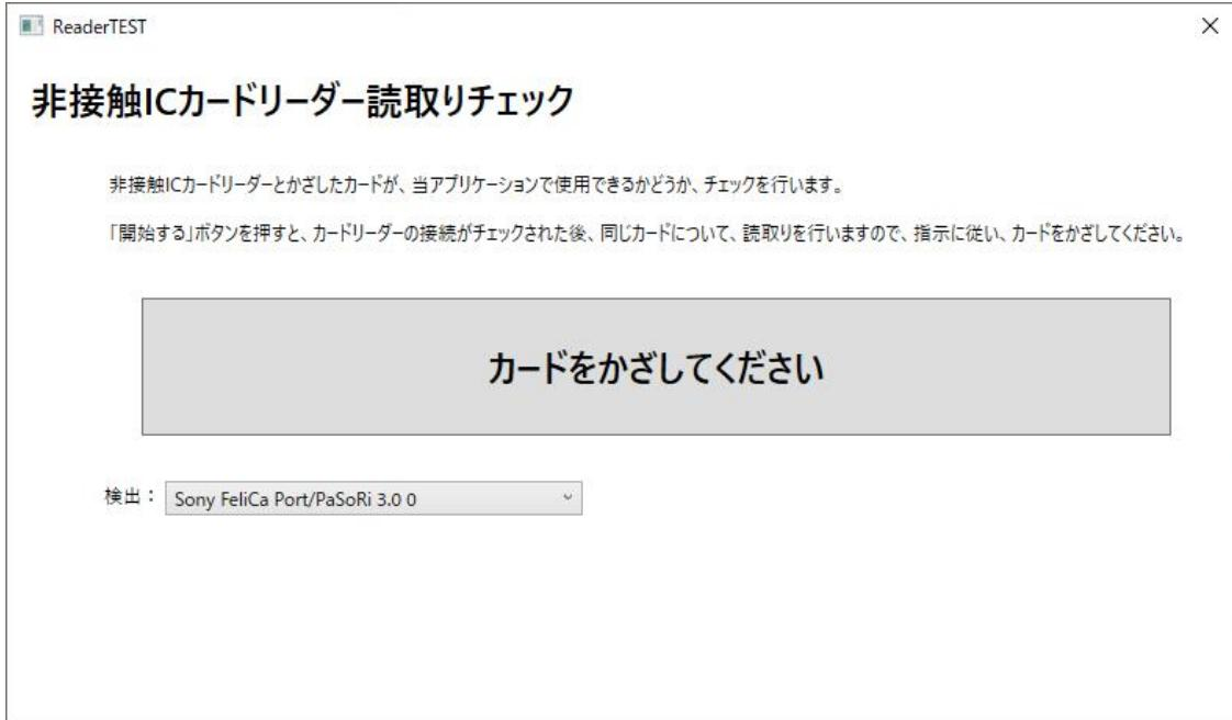
カードをかざして頂くと、読み取ったカードのIDと読み取り結果が表示されます。正常終了となれば、リーダとカードいずれもご利用頂けます。
