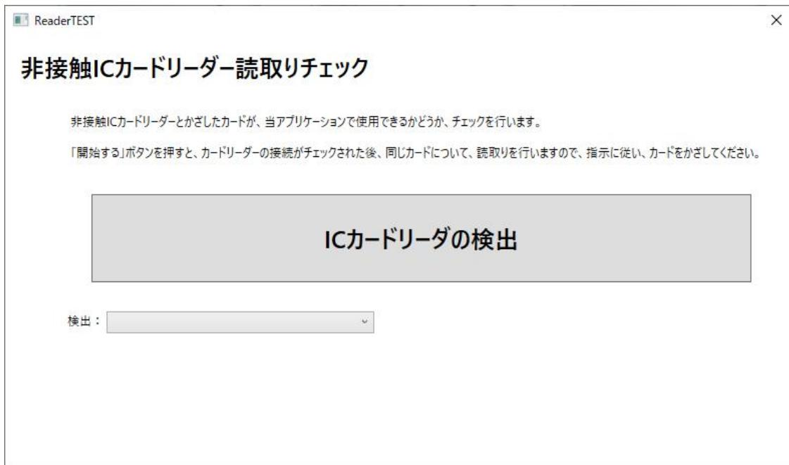
カードリーダが認識できると、ボタンが「開始する」に変化します。検出プルダウソーンには検出できたカードリーダの情報が表示されます。複数リーダを接続している場合は読み取りを確認したいリーダを選択してください。
